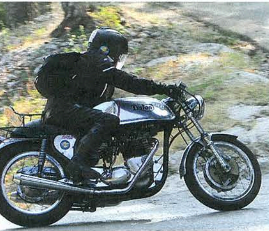
Jean-Paul Aujard possède ce très beau Triton depuis 13 ans sur base de T140. « Je l'ai un peu personnalisé : carbu Dell'Orto, fourche Ceriani, moyeu conique, réservoir 20 litres au lieu du Lita, frein quatre comes ».
